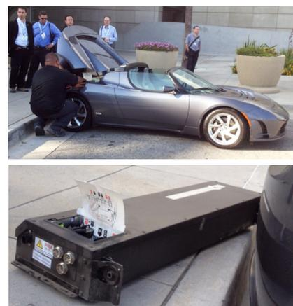
Figure 6 試乗会場横での電池交換のデモンストレーション
