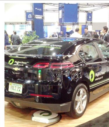
Figure 5 PluglessPower 社の非接触充電器
