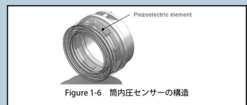
Figure 1-6 筒内圧センサの構造
