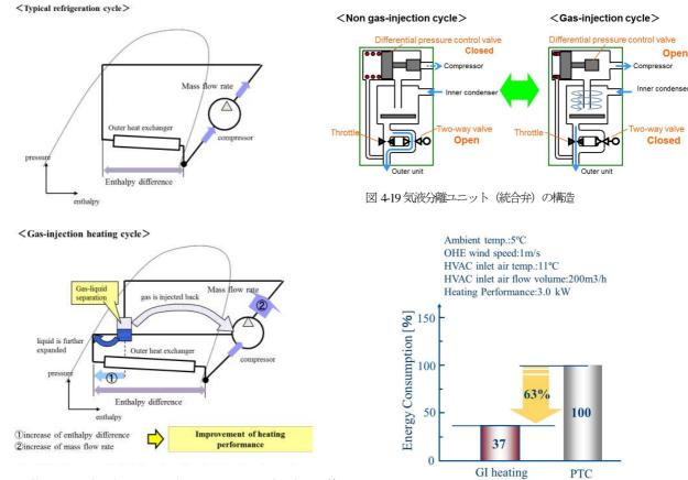
図 4-18 標準的なヒートポンプとガスインジェクションヒートポンプのP-h 線図
