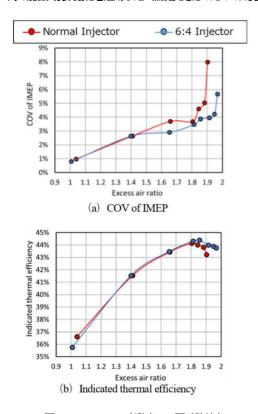
図 2-10 (a) IMEP 変動率 (b) 図示熱効率
