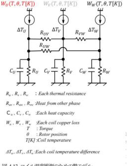
図 4-13 コイル温度推測のための熱モデル
