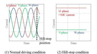
図 49(1) 回転時と (2)停止時の各相の電流波形
