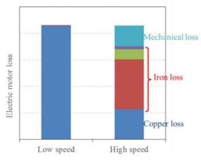
図 4-12 モータ損失要因とその比率
