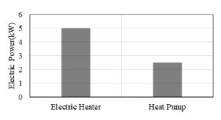
図 4-23 ヒートポンプの電力消費の改善度
