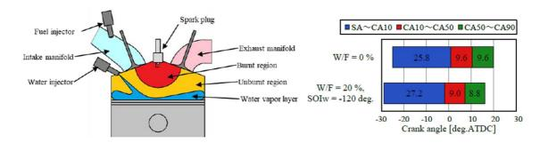
Fig.4-1 水噴射による冷却損失削減手法
