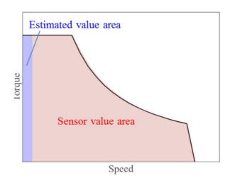
図 4-15 コイル温度評価元 (センサー温度/推測温度) の選択マップ
