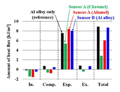
図2-1 熱流束の計算結果
