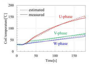
図 4-14 車載レベルでのコイル温度推定値の確認結果
