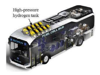
図 46FC バスの水素貯蔵タンクの配置
