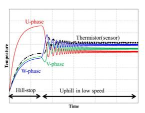
図 410 ヒルストップから走行開始時の各コイルとサーミス
