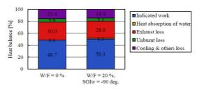
Fig.4-7 最大熱効率点でのエネルギー収支比較
