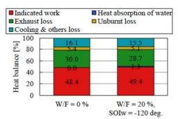
Fig. 4-3 水噴射時のエネルギーバランス
