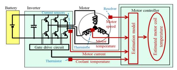
図 411 コイル温度推定モデルとそのパラメータ/検出器
