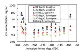
Fig.4-15燃料噴射時期に対する排出すす濃度
