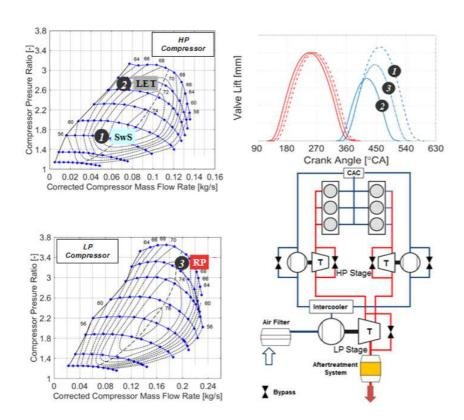
図 2-6 2 ステージ過給システム&カムプロファイルと位相
