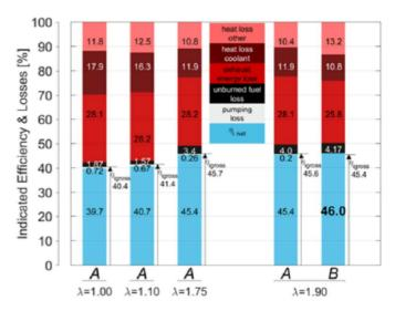
図 2-7 図示熱効率と熱損失
