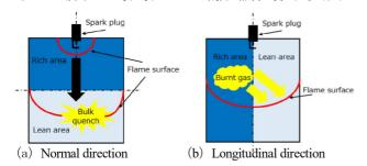
図 2-8 2 種類の混合気成層状態
