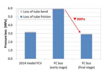
図 47 水素貯蔵システム内の圧損の比較
