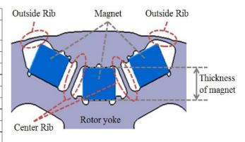
図 4-16 開発モータのロータの構造
