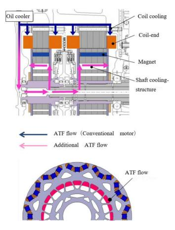
図 4-17 開発モータの冷却方法
