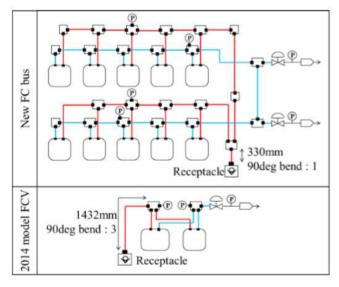
図 4-8 水素貯蔵タンクシステムの配管系
