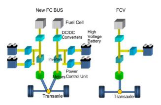
図 44 乗用車FCV と開発FC バスのFC システム
