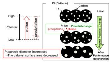
図 41FC の性能低下のメカニズム
