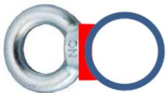
アイボルトの溶接例
