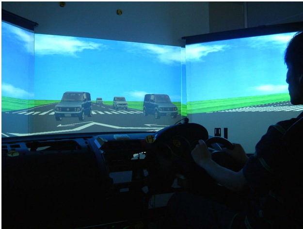
交差点での右折行動の分析を目的とした実験風景 (広視野角ドライビングシミュレータ)
