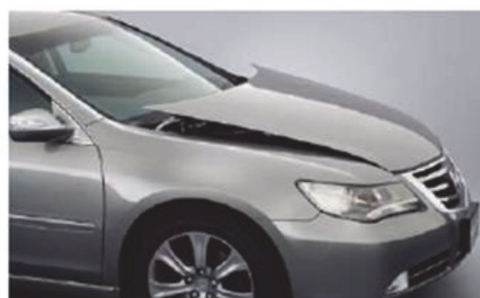
Fig.9 Hondaレジェンドのポップアップフードシステム
