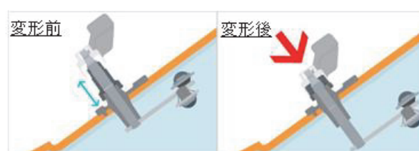
Fig.7 衝撃吸収ワイパーの脱落構造
