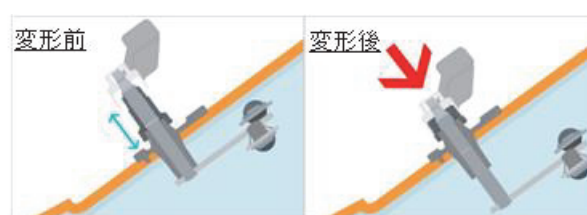
Fig.7 衝撃吸収ワイパーの脱落構造
