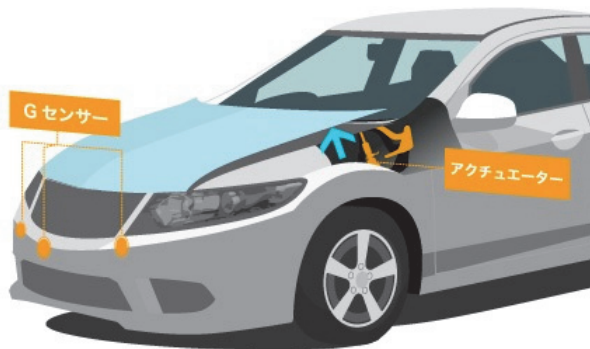
Fig.10 ポップアップフードのシステム構成
