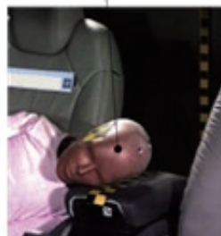
Far-side airbag (Center airbag)
