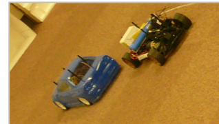
搭載カメラで青色の先行車を認識、車両投影面積の変化で衝突前に減速制御、停止した追従車両モデル
