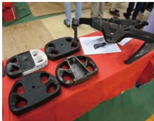
U.A.S.Graz車両の主骨格はC(カーボン)FRP成形・2分割構造であり、前半のcockpit「タブ」はロールオーバー面を終り、その背面部に後半部を構成する成形部品がボルトオンされる。写真右側の複雑な成形品がそのフレームであり、これが左右一対あって、エンジン、デフケースを両側から挟み込んで固定する。つまりパワーユニットはほぼリジッドマウントされる。こうした骨格構成であれば、彼ら自身が「スペースフレーム」と称するこの後半部をCFRP成形品とする必然性は薄い。その形状・構成から見て、骨格剛性としてもモノコックタブとの結合面に変曲点が現れやすい。左側はステアリングホイールの成形過程。今日のレース専用車両で一般的な構造・製法である。
