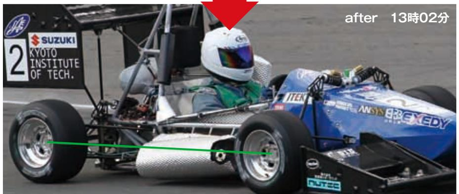
比較で明確に下がっていることが分かります。また、右の前面上方からの写真では、排気管出口フランジの角度を延長した緑色の線とメインフープの角度の比較で角度の変化が明らかです。マフラーの固定方法が不適切であったと考えられます。また、このチームはエンデュランス審査後の排気音測定で音量の規定値をオーバーして20点のペナルティーを受けています。規定値オーバーはこの影響があったのではないのでしょうか。
