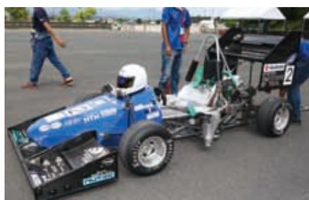
もウイング面の平滑性と審美性を損ねています。フロントの2段目の翼の内側のブラケットは、本来は間に板を挟む設計だったと見受けられますが、実際はブラケット間にはスペーサーが入っており、ブラケット2枚のさらに内側に板が来てしまっています。
