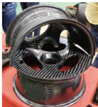
C(カーボン)FRP成形のホイールとそのカットサンプル。分割型に積層成形する製法であること(他の選択肢もあるのだが)、レース専用車両では常識のセンターロック方式であることが見て取れる。複合材成形品のホイールは精度を確保できれば作れるものだが、試作段階でこのように切断、構造検査・検証を行なうことは必須である。ホイールの鍵を握るのは、円精度だけでなくタイヤのビードは嵌まり込むリム部の形状、精度、剛性。U.A.S.Grazもブレーキテストでは軽合金ホイールを使用していたという目撃証言もある。
