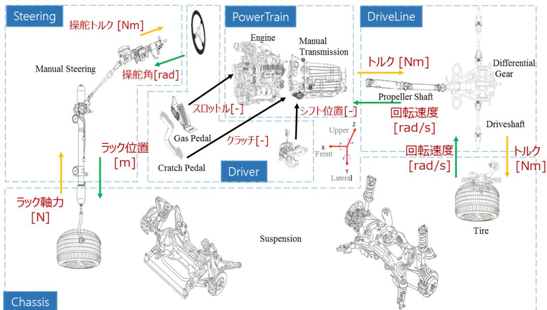
図 3.3.1-1 ベンチマークモデルの概要
