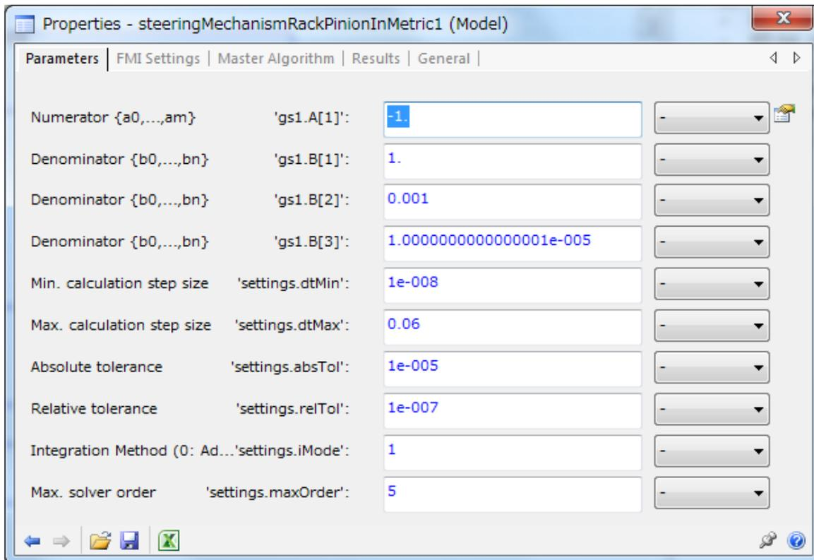
図 3.3.4-2 ステアリングのパラメータ設定 (SimulationX での例)
