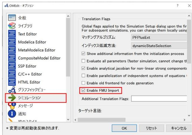
図 1.11.2-1 Enable FMU Import を有効化
