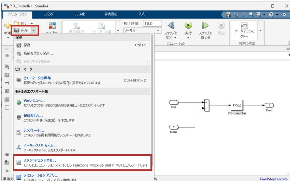
図 1.3.1-1 Simulink モデルから FMU エクスポート
