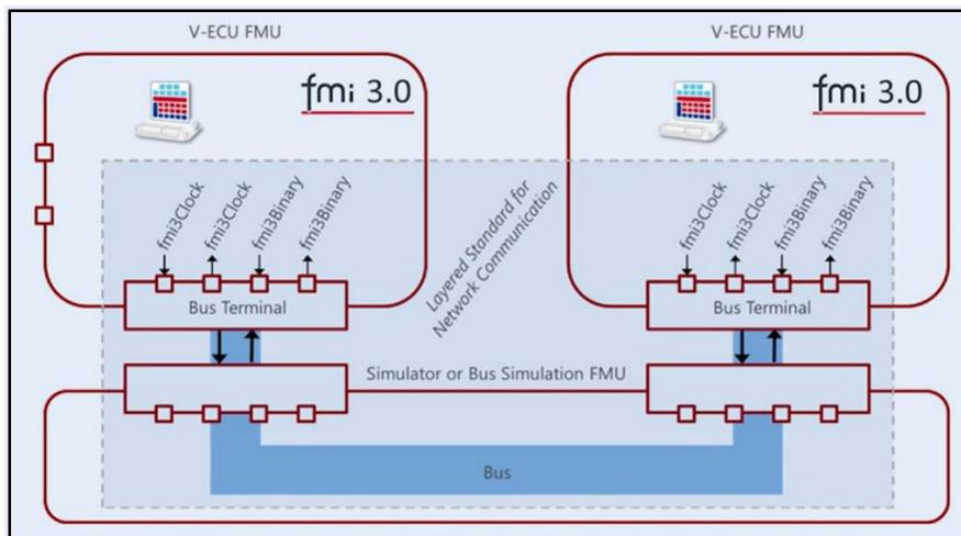
図 1.5.3-3 FMI3.0 の Binary 及び Clock 信号の実装
