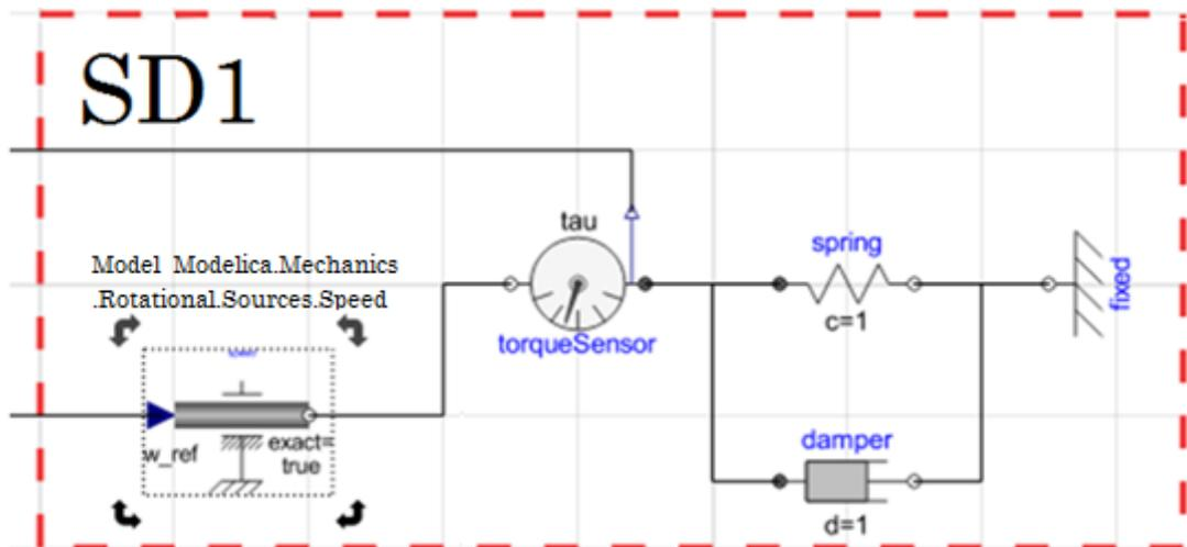
図 3.2.2-2 オリジナルの Modelica (SD1 モデル) の構成
