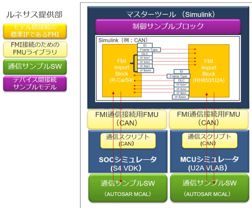
図 2.4.3-1 FMI で接続されたモデル間における CAN 通信の実現方法
