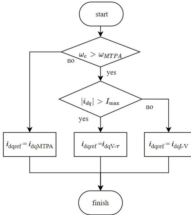
図 2.1.2-3 IPMSM control flow chert
