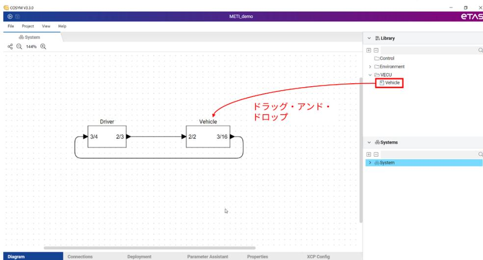
図 1.8.2-2 シミュレーションするシステムへの FMU の配置
