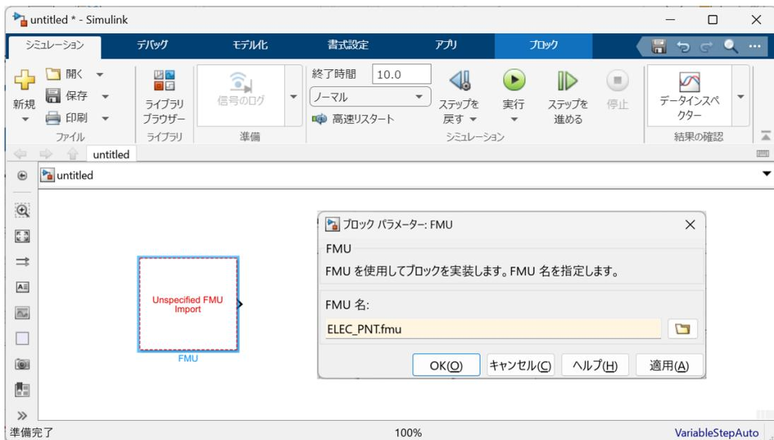
図 1.3.2-1 Simulink モデルへの FMU のインポート
