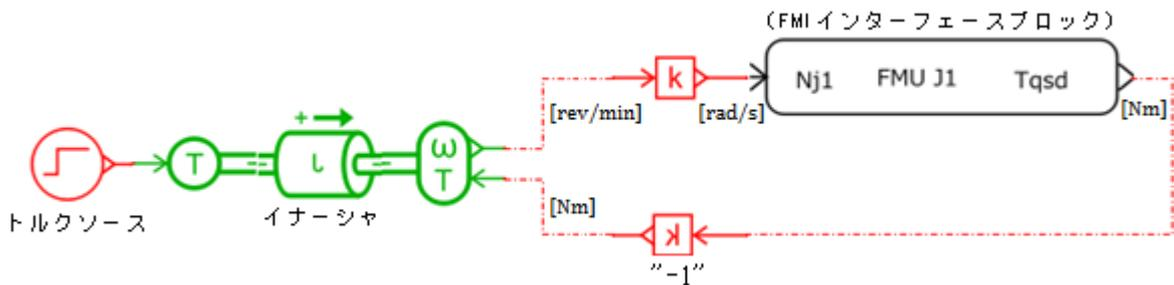
図 3.2.1-1 FMU1 出力用 J1\_Amesim\_CS.ame (J1 モデル)の構成
