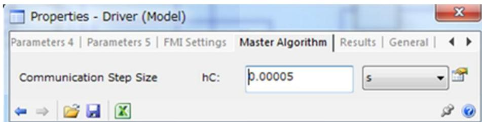
図 3.3.6-1 Communication Step Size の設定 (SimulationX での例)
