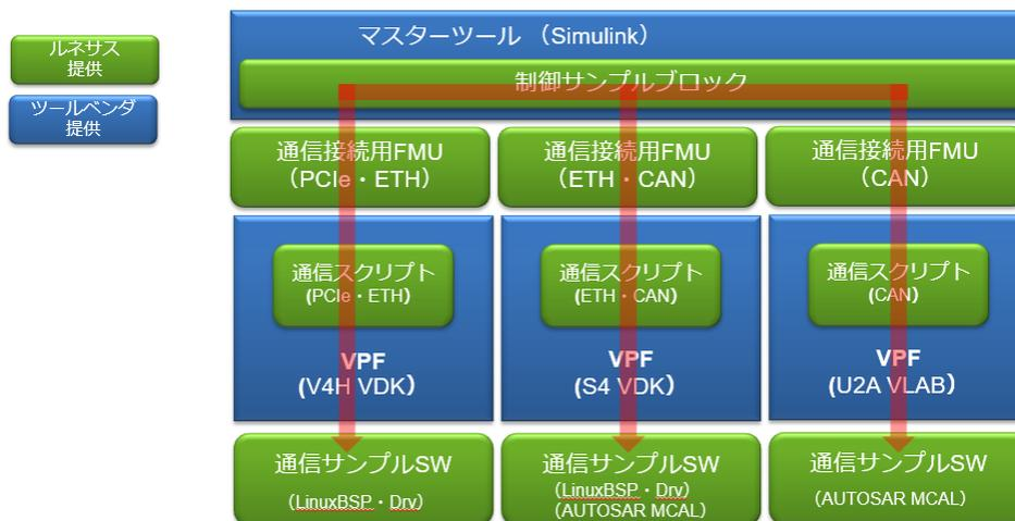
図 2.4.2-1 マルチデバイス用協調シミュレーション環境の構成
