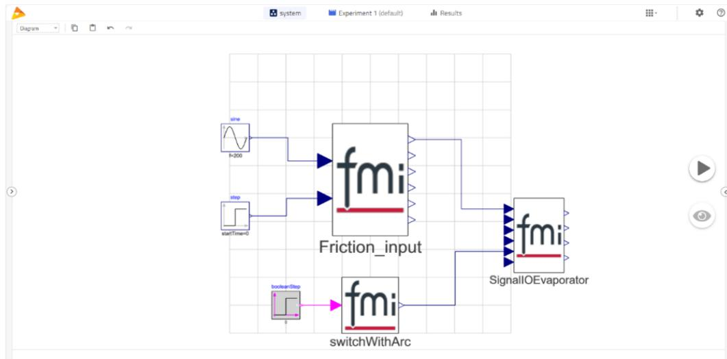
図 1.9.2-5 複数 FMU で構成したシステムモデル例
