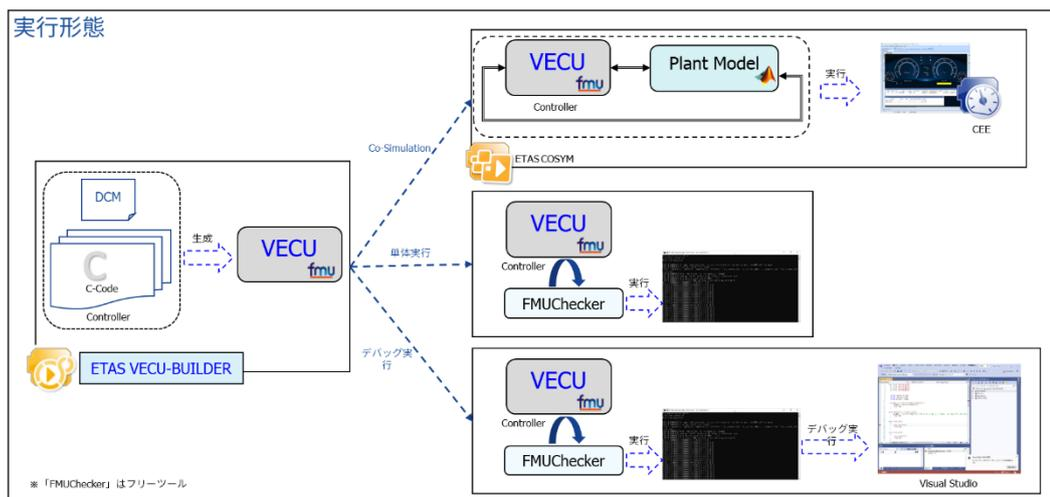
図 1.7.2-1 VECU-BUILDER とツールチェーン構成例
