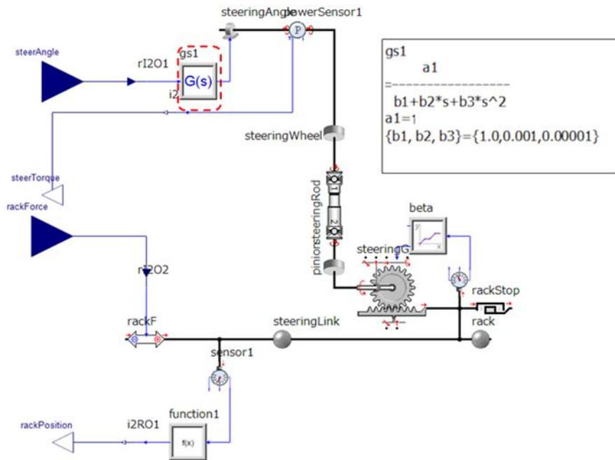
図 3.3.4-1 ステアリングモデルの概要
