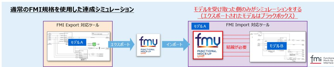
VenetDCP を使用した連成シミュレーションでは、モデルを受け渡さずに元のシミュレーションツールに置いたままシミュレーションできます。この場合、各モデルには VenetDCP が生成する FMI 通信機能ブロック「バスコネクタ」を組み込む必要があります。このバスコネクタは、FMI2.0 形式の FMU で作られており、FMI2.0 インポートに対応するシミュレーションツールで使用できます (FMI3.0 のサポートも計画しています)。
