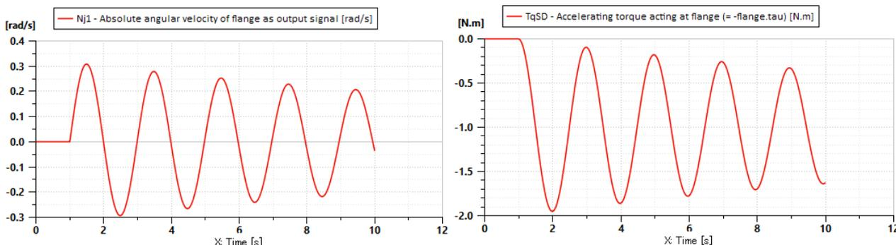
図 3.1.2-5 シミュレーション結果 (ME: パラメータ変更後)
