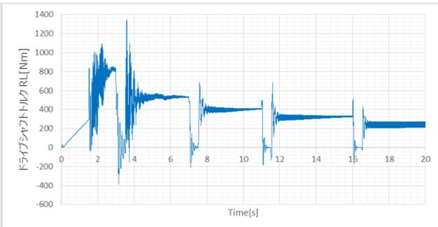
図 3.3.7-1d FMU3 (出力) 後左軸 D/Shaft トルク
