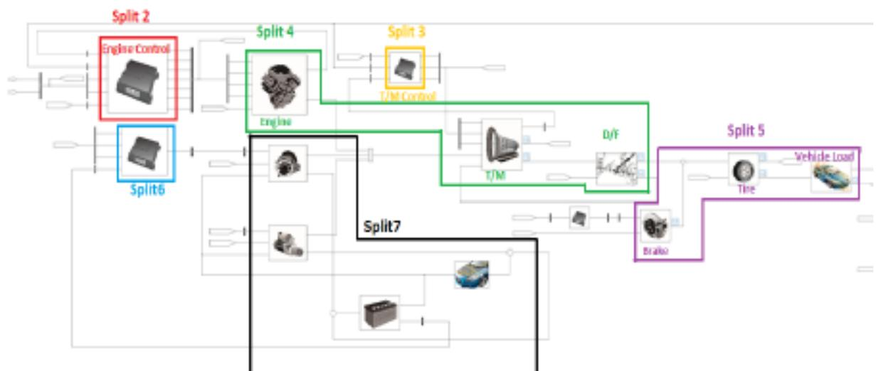
図 3.4.1-2 経産省ガイドライン準拠モデル Vehicle model の構成
