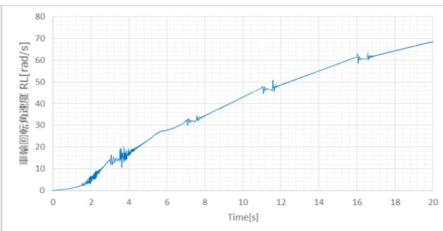
図 3.3.7-1f FMU4 (出力) 後左軸 D/Shaft 回転速度
