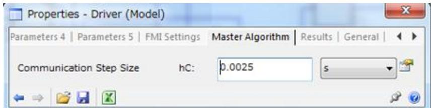
図 3.4.5-1 Communication Step Size の設定 (SimulationX での例)
