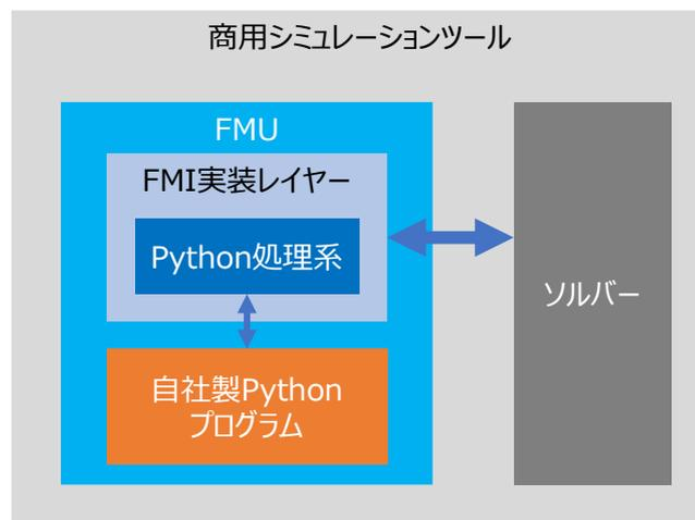
図 2.3.3-1 Python 処理系を組み込んだ自作 FMU を実装する場合
