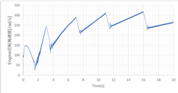
図 3.3.7-1b FMU2 (出力) エンジン回転速度
