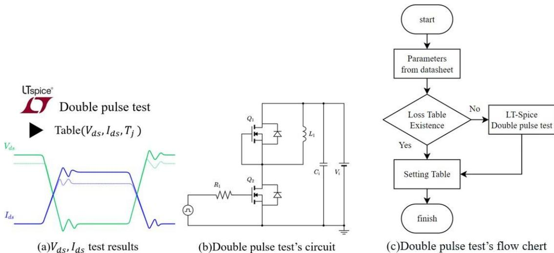
図 2.1.2-5 Double pulse test
