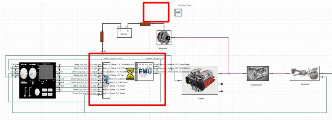
バスコネクタを組み込んだモデルでシミュレーションを開始すると、バスコネクタは自動的に「分散連成シミュレーションコントローラ」に接続されます。すべてのバスコネクタが接続されることで、分散・連成シミュレーションが開始されます。
