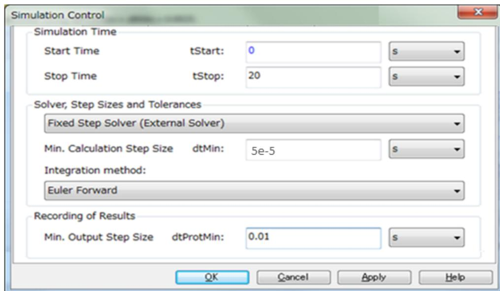
図 3.3.5-1 シミュレーション設定 (SimulationX での例)
