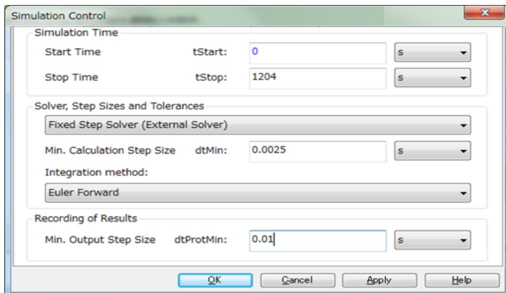
図 3.4.4-1 シミュレーション設定 (SimulationX での例)
