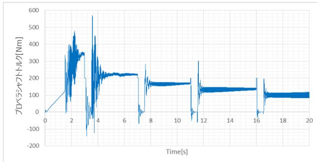
図 3.3.7-1c FMU2 (出力) Prop/Shaft トルク
