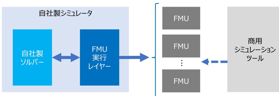
図 2.3.2-2 自社製シミュレータ側に FMU インポート機能を実装する場合
