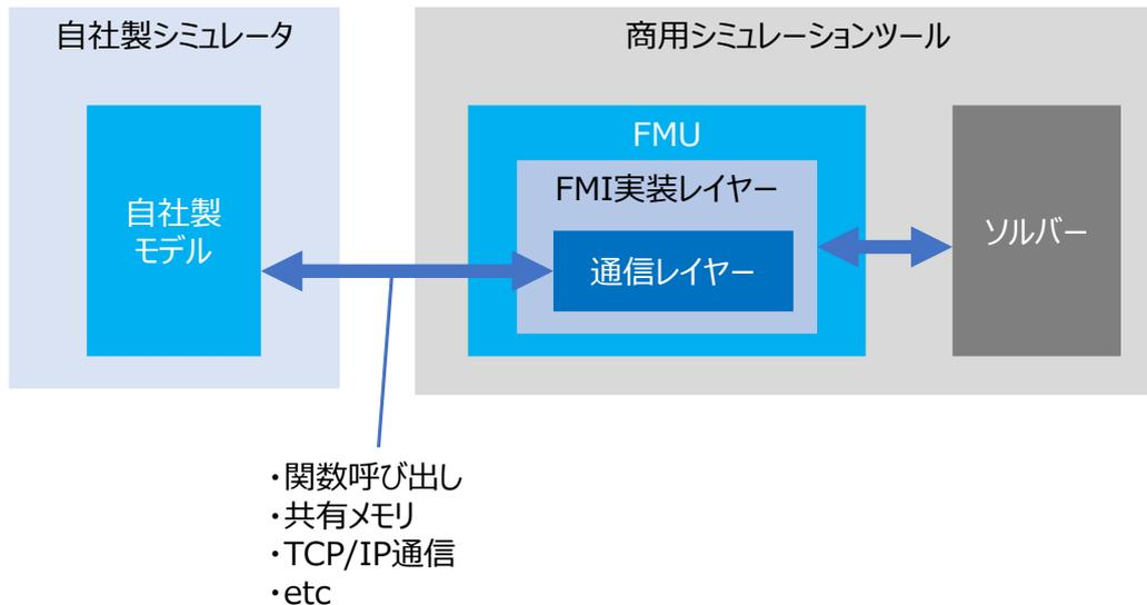
図 2.3.2-1 自社製シミュレータ側で FMI を実装する場合
