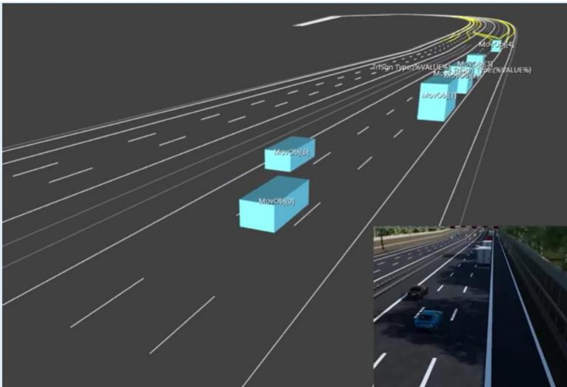
図 1.5.3-5 OSI を用いたトラフィックシミュレーション結果
