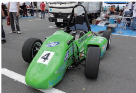
OFRACの昨年まで開発してきた「基本性能の向上」から今年度は一歩踏み出し、「コーナー脱出性能」に磨きをかけるため1年間開発を行ってきました。そのためには立ち上がり時の内輪浮きを抑制することが大きな課題となりました。このために低重心化が必要となり、エンジンのドライサンプ化に取り組むことによって、約20mmの重心高低減を実現しました。さらにエンジンの出力向上を狙い、ロータリーバルブスロットルを開発し搭載、変速時の駆動ロス低減のためにシフトアップ時の点火遅角制御にも取り組みました。また車両全体でドライサンプによる重量増をカバー
