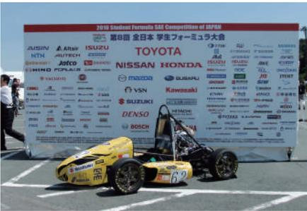
開発コンセプトは高出力、高剛性、高耐久性です。低回転から高回転までの吹き上がりの良いパワートレイン、高剛性フレーム、ドライバーに安心感を与え、メーカーとしてのブランドの強化を目指しました。ホイールベース1700mm、トレッド1200mm、全高1183.7mm、全幅1388.2mm、全長2852mmとしました。販売戦略は当社のショップは持たず、レース業界への参入、サービスの充実としました。収入見込みは約4億2500万円、ターゲット層は40～59歳としました。
