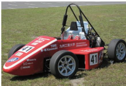
今年度のマシンコンセプトは「サンデードライバーの楽しめるマシン」と設定し、多様なコースに対応可能で幅広いドライバーに選んでいただける車両設計を行いました。具体的には、フォーミュラマシンらしいアクセルレスポンス重視の吸気システムや、タイヤ性能を限界まで引き出すジオメトリ設計、簡易にサスペンションセッティングの変更可能なことによる多彩な走り方の実現等が挙げられます。それらの思想を実現させるため、3次元設計ソフトCATIAで全パーツの設計、組付けまで行った上で製作を行いました。これにより、設計段階で重心等の管理が可能となり、また
