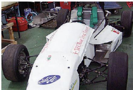
当チームの2010年度の車両は、「軽量かつコンパクトでシンプルなマシン」を掲げて昨年度のマシンデータをベースにマシン開発を行いました。昨年度の車両を見直して、軽量化・コンパクトを追求することでパワーウエイトレシオを向上させて、大出力マシンに負けないマシンを目指しました。それだけでなく、初心者でも気軽に運転できるようにコックピット内部も全面改良し、快適性と安全性も追求しました。
