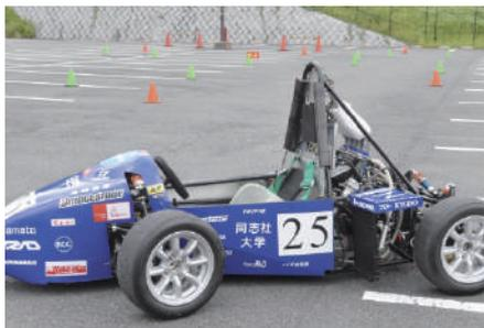
同志社大学フォーミュラプロジェクトでは『レースで勝利するマシン』を目指しました。そこで、「速くて操作性の良い車両」をマシンコンセプトとして今年度車両であるDF10の開発。よって、レーシングカーとして絶対的な「スピード」を引き出すために【マシンの軽量化】【居住空間確保】【操作性の向上】を高次元で実現させることに重点を置いた開発にあたりました。エンジンは高回転側のパワーを犠牲にすることなくターゲットバンドである6000～8000rpmのパワーを飛躍的にUPさせる調整を行うことで、扱い易いものとなり、吸気系に流体解析や慣性吸気の考え方も考
