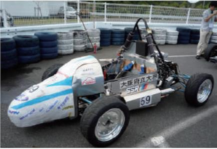
2010年の車両コンセプトは「安定して曲がる車」でした。大会コースレイアウトはストレートが少なく、ヘアピン、シケイン、スラロームなどタイトなコーナーが多く、コーナリング速度と立ち上がりが必要だと考えました。そこで、低重心化、-30kgの軽量化、低速トルクの向上、タイヤのグリップを活かすサスペンションジオメトリ、車両重量配分47:53を目標に掲げました。
