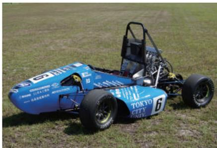
今年度車両M2010は「コーナー脱出速度を速く」をコンセプトに昨年度M2009で問題の加速力を改善すると共に、旋回性能とドライバビリティの更なる向上を目指しました。搭載エンジンを単気筒CRF450より四気筒CBR600RRに変更し、出力は36PSから88PSと大幅に増加すると共にギア比の変更、吸排気設計においてアクセルレスポンスが向上しました。旋回性能の向上ではサスペンションジオメトリーだけでなくフレーム剛性から考えた対地キャンパ変化の抑制を狙うと共にパッケージレイアウトにおいて低重心、低慣性モーメントを重視して設計。また従来のペダル、
