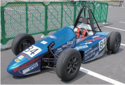
入れた車両をめざしているため、大型のショックアブソーバ、ロングホイールベース、高剛性フレームを採用しているため総合力の高い車両に仕上がっています。
