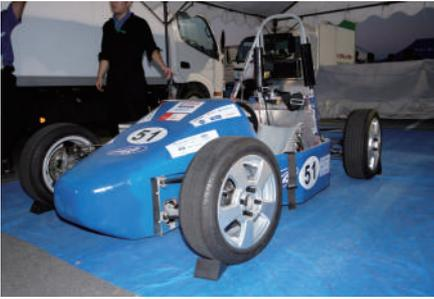
当チームの車両の特徴はサイドエンジンレイアウト、CVTエンジンを採用していることです。これらにより、低重心にすることが容易に可能となりました。また、吸気制限による影響を極力抑えるため、500ccの2気筒エンジンを採用しています。製作においては、設計・解析後にモックアップを製作することにより、各コンポーネントの配置確認や、干渉のチェックを行いました。設計→解析→モックアップを繰り返し行いフィードバックを与えることにより、設計を煮詰めていきました。CAE解析の他に、複合領域物理も出るシミュレータを使用したサスペンションのシミュ
