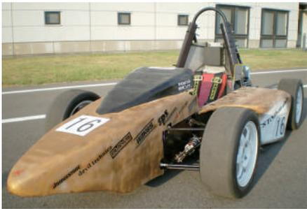
今年度の車両のコンセプトは前年度のコンセプトを引き継ぎ、コンセプトへのアプローチを変える方針でプロジェクトを進めました。今年度はエンジンが変わるということもあり、エンジンの測定から始まりフレームの設計、足回りの設計と流れて行きました。製作に入るとエンジンマウントの位置出しが上手くいかず、エンジンを正確に測定するのが難しいと実感しました。また、今年度エンジンを新しくすることは私たちにとって挑戦でした。渉外先のヤマハ様からも電子スロットルの解除はサブコンでは無理と指摘されいろいろ悩みましたがフルコン化という選択肢のもと
