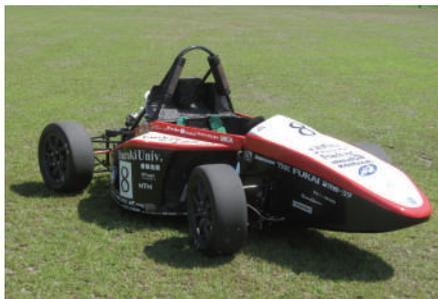
IUSI-06は、“旋回性の追及”をコンセプトに製作しました。このコンセプトは、大会で使用するエンデュランスコースのレイアウトを検討した結果、コーナリング動作のタイムを削減した方がより効率的であるという結論から考え出されたものです。昨年から変更点としては約10kgの軽量化や50mm以上の低重心化、ヨー慣性モーメントの5%削減が挙げられます。設計時には、パッケージングレイアウトには特に力を入れ、重心、慣性モーメントの見直しを徹底的に行いました。各パートでFEM解析を駆使し、最適設計によるパーツ重量の見直しを行いました。また走行時に
