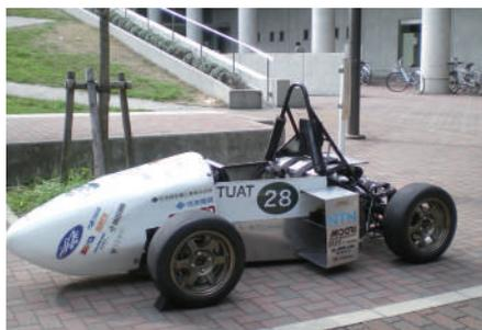
今年度私達が設計した車両（以下、NK06）は“Amuse”をコンセプトと掲げ、ドライバーが操縦を楽しめる車両を目指しました。具体的にはバランスのとれた高い運動性能と、操縦性と安定性の両立によるドライバーの意図に忠実な車両特性を目標としました。さらに商品性向上のために生産性・安全性にも重点を置いて開発しました。
