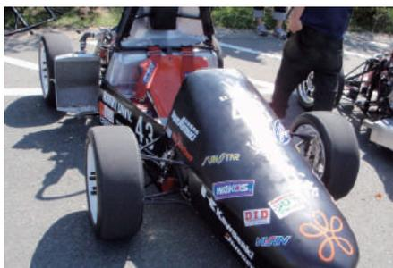
本年度大会出場車両KFR-07は、「Fit on」というコンセプトのもとで「ドライバーに適した車両」を目標としました。パワートレイン設計では、「扱いやすさ」「整備・セッティングのしやすさ」「信頼性の向上」に重点を置き設計を行いました。エンジンは、昨年度までの500cc 2気筒から新たに川崎重工業様の製品であるZX-6Rの600ccの直列4気筒エンジンを採用。サスペンション設計では、「どのようなドライバーでも容易に運転・調整ができるサスペンションの実現」を目標とし設計を行いました。ジオメトリでは、前後バランスからスタビリティファクタがゼロになるように
