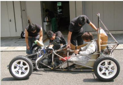
AGRCのデビューマシン“AGF-01/10: CARROT”は「珍しい・美しい・シンプル」コンセプトの元、ホビー向けレーシングカーとして所有する喜びに直接訴える、存在の魅力・かっこよさを追及しました。駆動には、F-*SAE*史上初であり現代フォーミュラでは見られない、FR（フロントエンジン・リアドライブ）方式を採用しました。これによってドライバーが後方に着座するスタイルを、より強調し独自の魅力を表現したボディカウルは、大量のイメージスケッチとクレイモデルによる慎重な検討により、他に類のない、魅力的なデザインとなりました。また空力デバ
