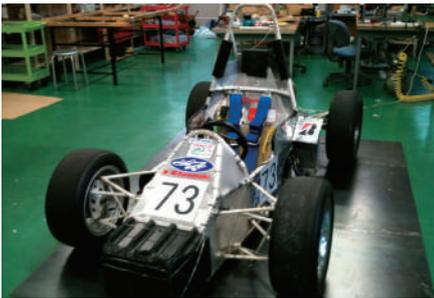
初年度の車両は、車重、重心高、ヨーモーメントの値を他大学のデータを元に、高いレベルで設定して設計しました。設計に丸一年、試行錯誤の末、目標値に近い値（車重5kg増、重心高達成、ヨーモーメント達成）にすることが出来ました。また車両の特徴は自作のサスペンションやステアリングを搭載しているところです。サスペンションは、学生フォーミュラの車両では珍しいかもしれませんが、トーションバーサスペンションを採用しました。車両性能、重量や生産コストの面で大きな効果もあり、革新性も期待できると考えました。また、ステアリングは軽量、低コストな自作
