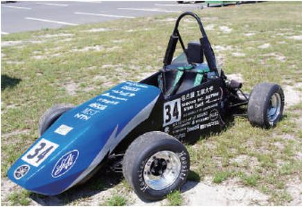
私達の車両はコーナリング最速を目指しているため、単気筒エンジンに10インチタイヤを組み合わせた、軽量かつコンパクトなパッケージングになっています。今年度は「Cornering Oriented」をコンセプトに旋回性能を大きく左右する軽量と低重心、低慣性の3つを中心に設計を進めました。具体的にサスペンションでは構成部品の軽量化や、コンプライアンスの検討、プルロッド式サスペンションの採用、アームは位置の変更、ヘルクランクのレバー比の最適化を行いました。フレームでは、サイドインパクトの設計変更や、サイドパネルの材質変更によって昨年度の
