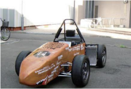
今年の私達のコンセプトは「質の向上」です。昨年のマシンが大会出走まで後一步のところ部品が破損してしまったので、今年は昨年の改善を主に行いました。エンジンに関しては、排気管の管長や径の変更を行い、より低速側でのトルク特性を目指しました。また、実走テストによるデータロギングにより最適な電装セッティングを行いました。外装に関しては一体型のカウルをすることで着脱時間の減少、継ぎ目が減ることの見た目向上、FRP積層の見直しによる軽量化を行いました。サスペンションに関してはホイールベースの短縮による旋回性能の向上、ステアリング支持
