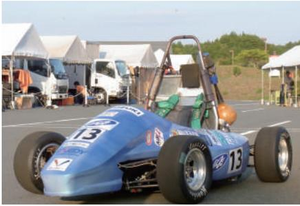
私達の車両GDF-05は、初年度からの「小型・軽量」コンセプトを軸に、サブコンセプト「低慣性マス・ドライバビリティ・信頼性」に「定量的な数値測定・安全性の向上」を加え、単気筒車両の最高峰を目指し、答えを出すという意味を込め、本年度のコンセプトを「Answer」としました。車両の特徴として、複合材料があります。アラミド繊維をFRP化した板を突き抜け防止板の代わりに使用。軽さと強靱性を兼ね備えた部品です。インパクトアッテネータやサスペンションアームなどには本学独自の技術として、組み紐複合材料を使用したカーボンFRPで製作。糸を編んで強
