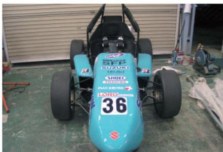
私達、静岡理科大学SIST Formula Project 2010年度のマシンのコンセプトはシンプル&コンパクトです。単気筒であることでコンパクトにまとめることができている。また、コーナリング性能では、MRダンパを搭載することでスタビライザーレスのサスペンションジオメトリにまとめることが出来ました。スーパーチャージャー+単気筒のレイアウトとなっております。単気筒の苦手である加速性能を克服するためスーパーチャージャーにより過給を行っています。
