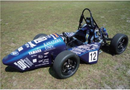
KF2010車両では開発コンセプトを「Total Performance」とし、レーシングカーの基本である「速さ」を基幹に、「環境性能」＝低燃費と、「安全性能」、これら3つの性能のバランスがとれた車両を目指しました。「速さ」ではコーナーの多いコースを速く走るために高い旋回性と加減速性能を目指しました。これを達成するためにパワートレイン設計としてはドライサンプシステムの採用、エンジンクランクケースの切削加工、カムプロフィールの変更、ツインインジェクションの採用、そして可変翼過給機の搭載を行いました。シャシ設計では部品の弾性変形を考慮したサスペ
