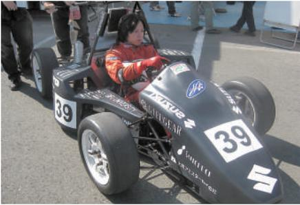
岐阜大学5台目となる車両、GFR010はF-SAE競技での勝利を目指すべく基本に忠実に「速さ」を求めました。すなわち、軽量・低重心・小慣性モーメント・ハイパワー・ハイレスポンスを徹底して追求し、レーシングカーとしてのシンプルな魅力を高めることを何より重視しました。またGFR009での設計の見直し、さらなる軽量化を行いました。「速さ」の具体的指標として、アクセラレーション競技で4.0秒、スキッドパッド競技で5.0秒を達成することを性能目標とし、それを成し得る車両スペックを昨年度大会の上位車両をベンチマークとして車両重量205kg、出
