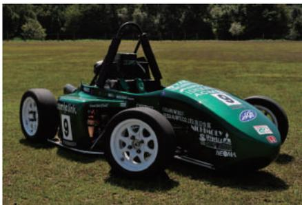
第8回大会出場車両「UF-08」は開発コンセプトを「Progress」とし、昨年度車両UF-07をベースに運動性能の向上はもちろん、この車両の一番の反省点であった「ドライバビリティ」の改善に着目し、新たに開発しました。ドライバーの乗車姿勢はフレームの1/11モックアップを用いて決定。シート的位置や角度だけでなく、ステアリング位置も含めて検討することで操縦性を高めたコックピットを実現しました。また、トレッドを50mm、ホイールベースを30mm短縮してコンパクトな車体とすることで回頭性を高めると共に、動的競技の狭いコース内での取り回し性を向
