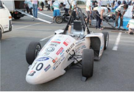
今年度の大会参戦マシン、FEM-07は、シャシとパワートレインに分けて2つの開発方針を立てました。シャシでは足回りパーツの剛性評価を行い、パーツの変位を考慮したサスペンションジオメトリを設計しました。パワートレインではエンデュランスでのエンジン常用回転域での出力向上を行い、主に吸気系パーツの一新を行いました。今まで設計、製作の期間が長く十分なテスト走行をせず大会に参加していたという反省を踏まえ、今年度はシェークダウンを早期に完了することで、テスト走行から得たデータをフィードバックし改良する開発をすることで上記2点の開発方針
