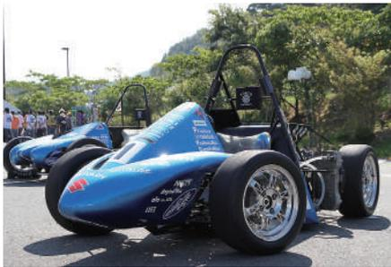
昨年度総合優勝をしましたが、車両重量の削減代が少なく、エンジン出力のさらなる向上も見込めないなど、パッケージが限界を迎えつつあることも事実でした。そこで、今後も総合優勝を狙えるマシンを開発するべく、UTFF11ではエンジン変更に踏み切りました。コンセプトは引き続き「Easy Drive」とし、軽量コンパクトな単気筒エンジンに電子制御CVTを組み合わせ、車両重量を削減し、運動性能の向上を目指しました。開発当初は、ターボチャージャーを搭載してエンジン出力を向上させる予定でしたが、開発は難航し、信頼性の問題から投入を断念せざるを得ませんでした。
