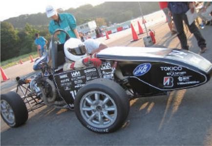
今年度車両(以下KU-009)はアマチュアレーサーがレースに参戦することを前提にし「走る・止まる・曲がる」を容易に行える車両を目指しました。安全で信頼性が確保されていること、メンテナンスが容易なこと、車両の特性を把握しやすく扱いやすい車両が求められると私達は考えました。それらを実現するためにKU-009ではオーバーハングやステアリングラックの取り付け位置の見直しを行い、ドライバビリティの向上を行いました。パワートレインではパワーバンドが広いエンジン特性を目指しターボチャージャーを搭載し、低速域での駆動力を確保しました。シャシでは拡
