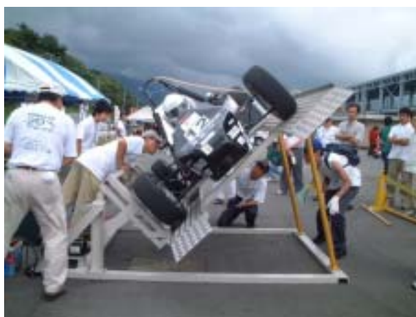
車検のひとつであるチルトテスト。最高57度まで傾ける。
