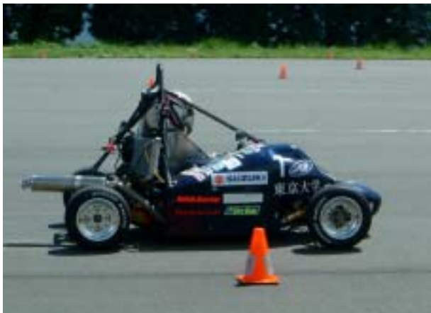
エンジンを人の横に置いたサイドマウントエンジンを採用した UTF02。ホイールベースの短縮がなされている。
