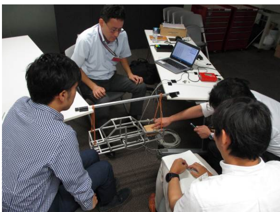
図1 車体模型の振動の再現
