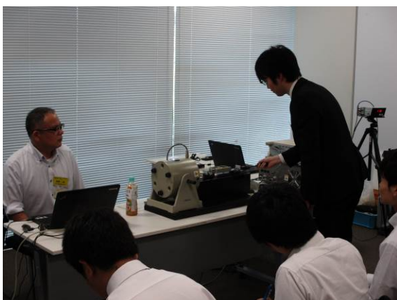
図5 クラッチモデルの加振実験
