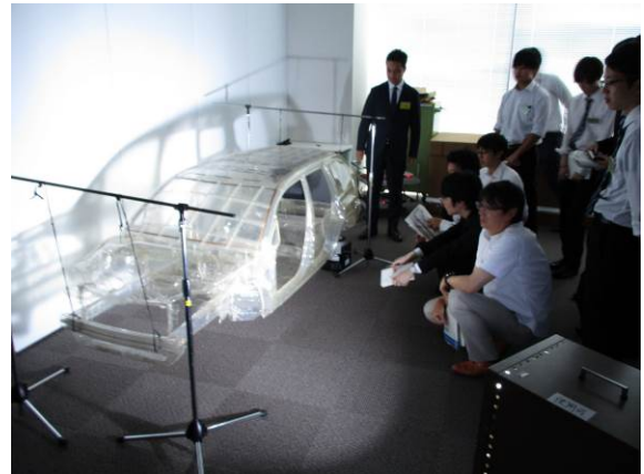
図6 車体プラスチック模型の加振実験
