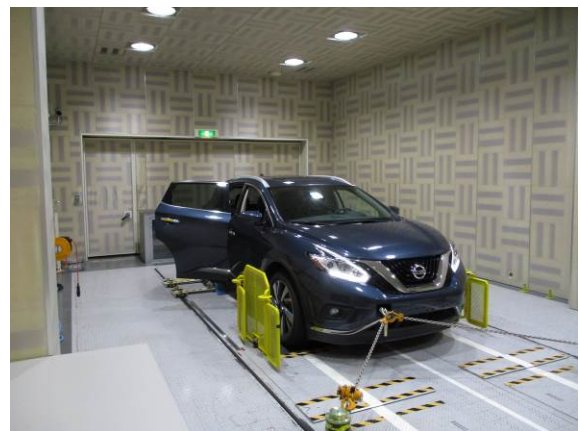
図2 シャシーダイナモ上の実験車両
