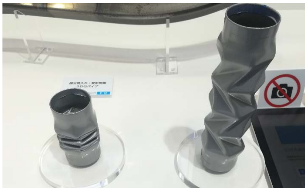
図 8 変形制御ハイドロフォームパイプ (右：変形前、左：変形後)
