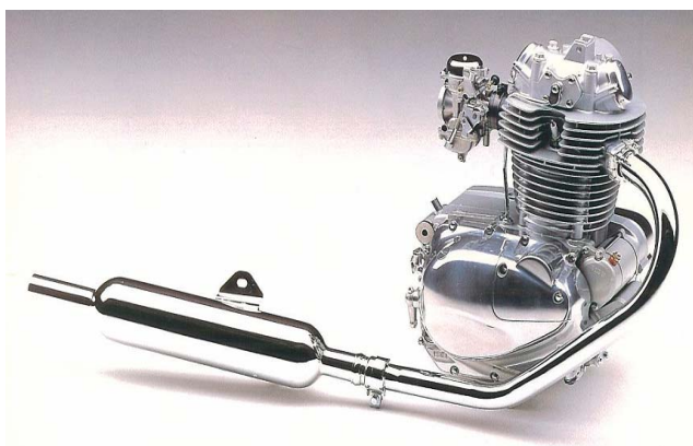
写真2 エンジン、排気系 外観
