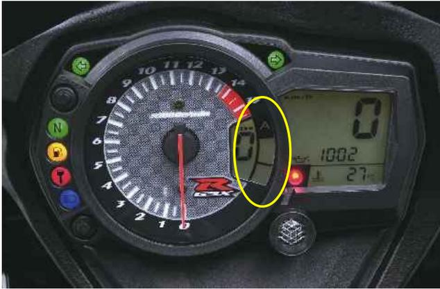
Fig.3 タコメーター右側のドライブモードインジケータ
