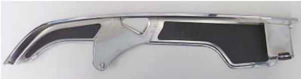
Fig.9 チェーンケース裏のダンパー (Fig.6③部の裏側)
