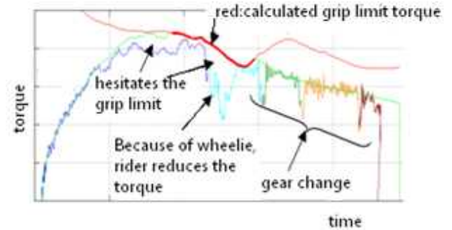
Fig. 6 限界推定システムと実際の制御結果
