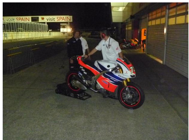
図6.スターターでエンジンをかける GP マシン
