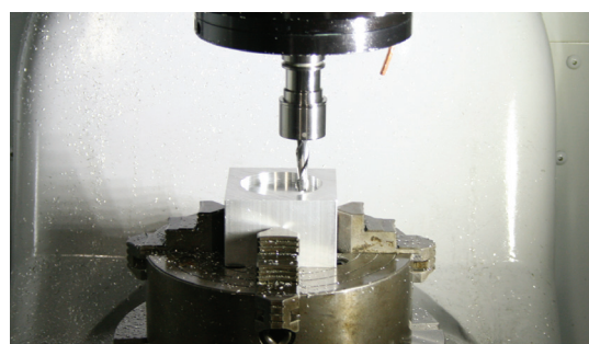
5 軸加工機による切削
